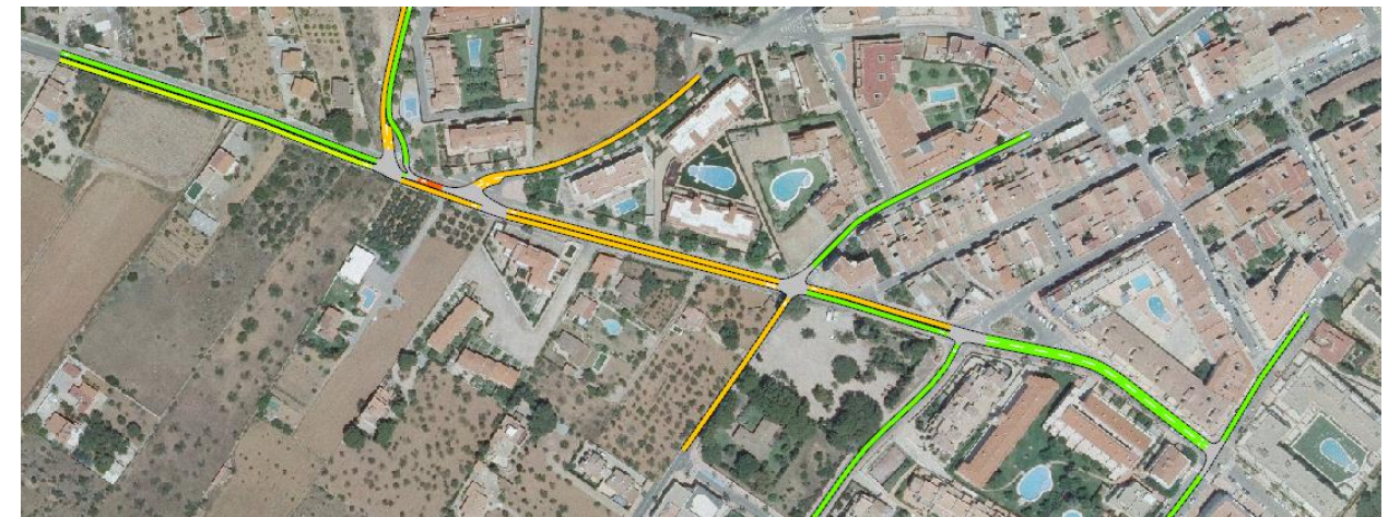
Ilustración 9. Propuesta de reordenación del tráfico zona Alcossebre centro y Costa Sur. En la imagen se observa el estado del tiempo de demora de la simulación de tráfico. Fuente. Elaboración propia a partir de los resultados del modelo de simulación Aimsun.
