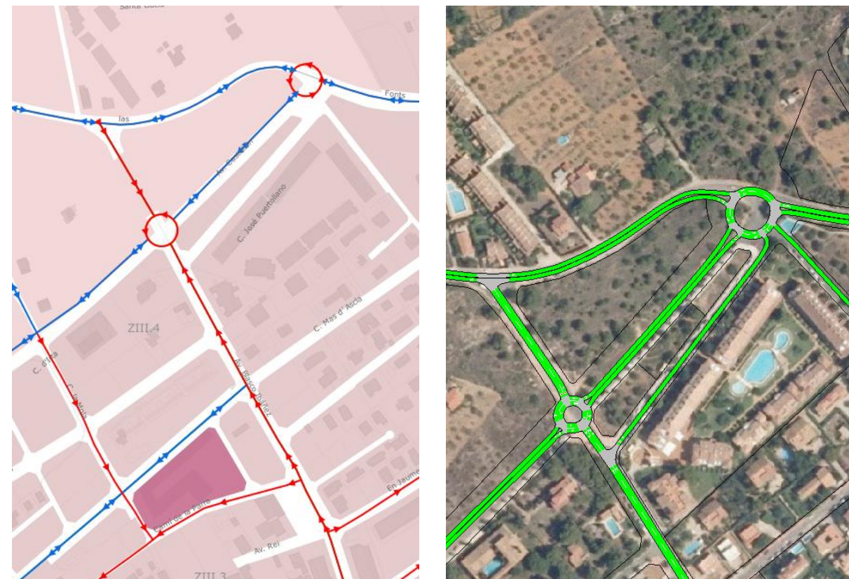
Ilustración 11. Propuesta de reordenación de Av. Castellón y Av. Blasco Ibáñez. En la figura de la izquierda se observa la propuesta de sentidos de circulación. En la imagen de la derecha se observa el estado del tiempo de demora de la simulación de tráfico. Fuente. Elaboración propia a partir de los resultados del modelo de simulación Aimsun.
